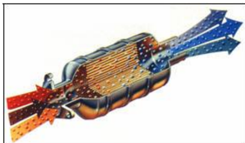
Εικόνα 1. Καθαρισμός των καυσαερίων με καταλυτική επεξεργασία
