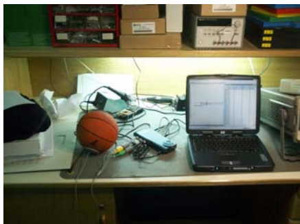
Σχήμα 4: Η «έξυπνη» μπάλα με το ενσωματωμένο επιταχυνσιόμετρο και οι πρώτες μετρήσεις
