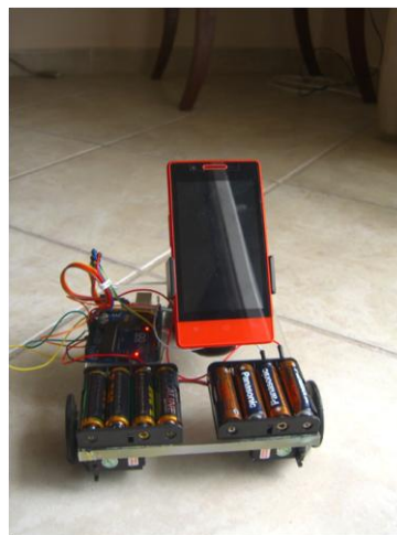
Εικόνα 2. Το ρομπωτικό σύστημα ολοκληρωμένο μαζί με την android συσκευή.
