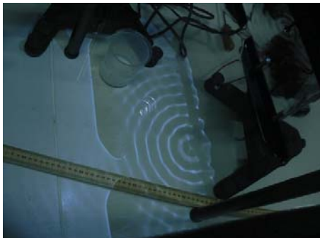
Σχήμα 7. Εμφάνιση στιγμιότυπου κύματος με την βοήθεια strobe-light
