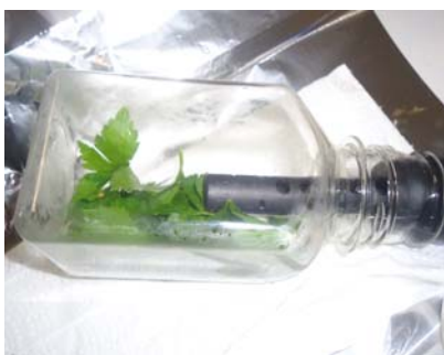
Σχήμα 3. Μετρητής CO 2 μέσα σε αεροστεγές μπουκάλι με σπανάκι
