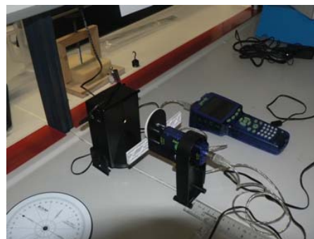
Σχήμα 6. Μέτρηση της έντασης φωτός με απομάκρυνση από την πηγή με χρήση GLX
