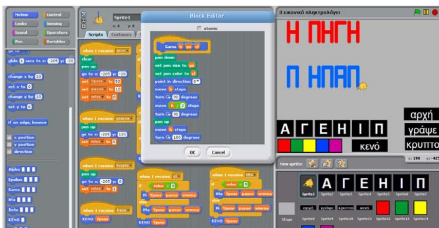
Εικόνα 6: Υλοποίηση του κρυπτογράφου με εικονικό πληκτρολόγιο σε BYOB
