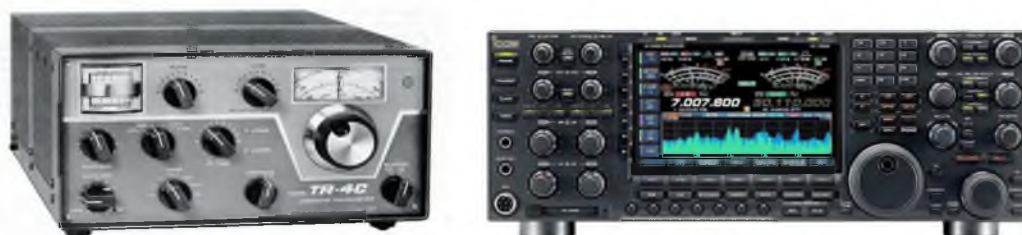
Εικόνα 5: Παλαιότερος (αριστερά) και σύγχρονος (δεξιά) πομποδέκτης βραχέων κυμάτων.
