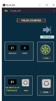
Εικόνα 7. Το panel PULSE COUNTER της εφαρμογής TimeR_SiM το οποίο προσομοιώνει έναν μετρητή παλμών
