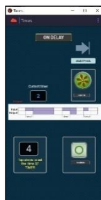
Εικόνα 4. Το πάνελ ON DELAY της εφαρμογής TimeR_SiM το οποίο αντιστοιχεί στην λειτουργία του χρονιστή με καθυστέρηση ενεργοποίησης
