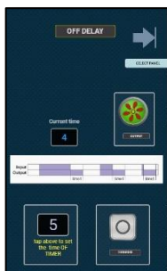
Εικόνα 5. Το panel OFF DELAY της εφαρμογής TimeR_SiM το οποίο αντιστοιχεί στην λειτουργία του χρονιστη με καθυστέρηση απενεργοποίησης
