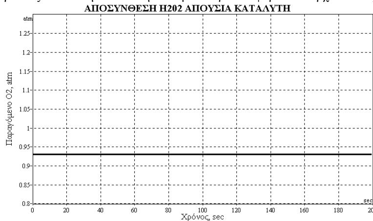
Σχήμα 2: Πείραμα 1- Διάγραμμα O 2 - χρόνου χωρίς καταλύτη
