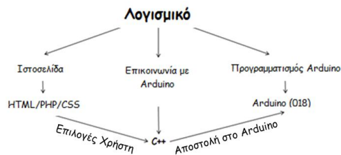
Σχήμα 2. Τα τμήματα του λογισμικού που απαιτείται για τη λειτουργία των πειραμάτων από απόσταση
