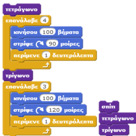
Σχήμα 10. Σύγχυση του μπλοκ κλήσης με το μπλοκ ορισμού
