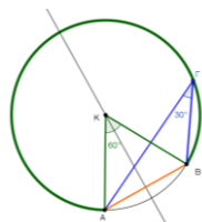
Σχήμα 6: Κατασκευή γωνίας 30^\circ με δύο σημεία στο επίπεδο Α, Β
